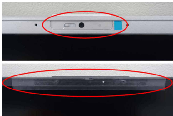
保護用のフィルムの例。機種によって保護用のフィルムの形状は異なります。
